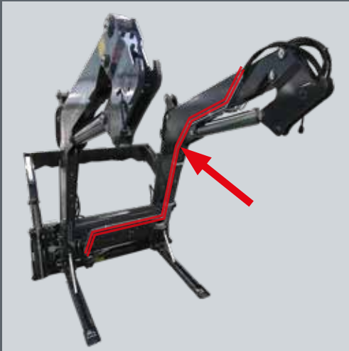
Pokládání trubek pro REAL3 rd
