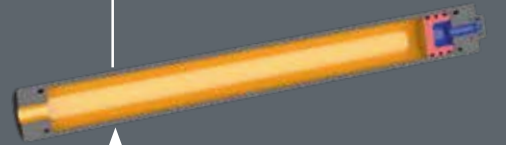
Pístový zásobník pro tlumení vibrací COMFORT-DRIVE uvnitř příčného nosníku
