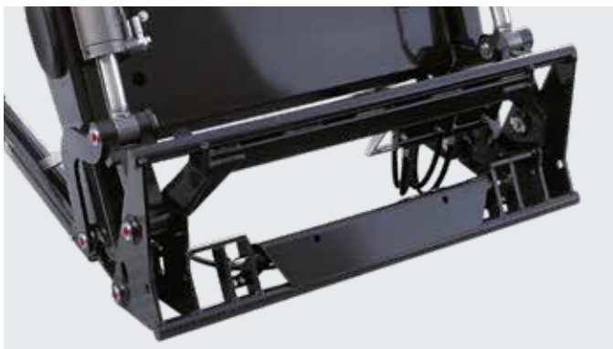
Uzamčení nářadí stisknutím tlačítka, ještě pohodlnější výměna nářadí bez vystupování – pomocí zámku HYDRO-LOCK.
